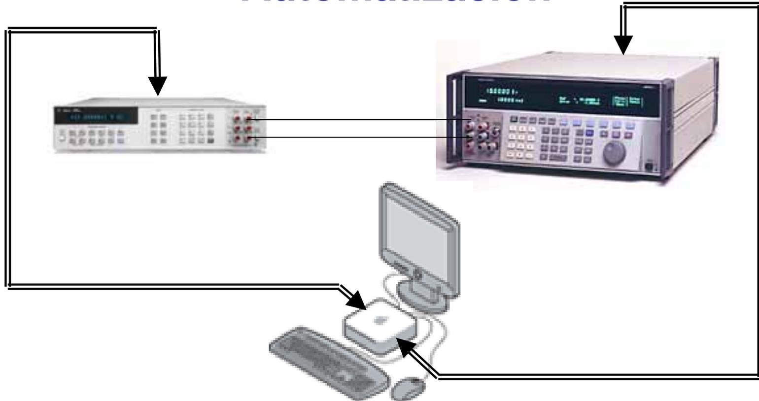
Escalamiento a cualquier valor desde 100 mV a 1000 V de manera automática en base a 1 valor de referencia dado por un Zener o un por un calibrador.
